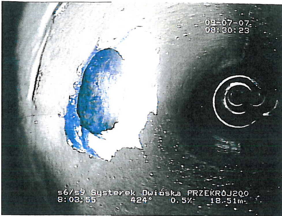
Zdj nr 6 – pęknięcie rury
