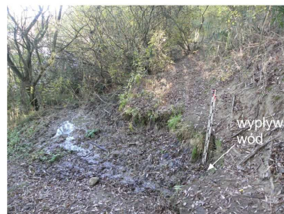
Fot.58 Wysięki wód u podnóża osuwiska w Pożegowie
