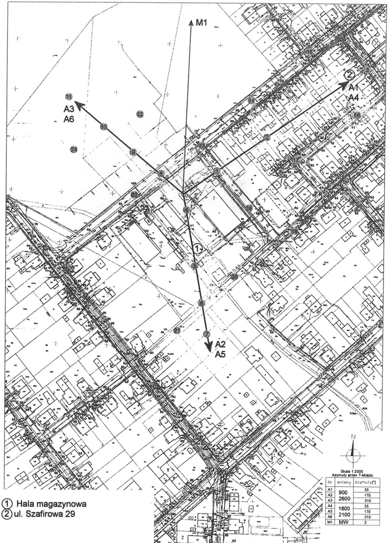
Załącznik nr 2: Lokalizacja anten oraz ich azymuty, lokalizacja pionów (punktów pomiarowych) wokół instalacji radiokomunikacyjnej.
